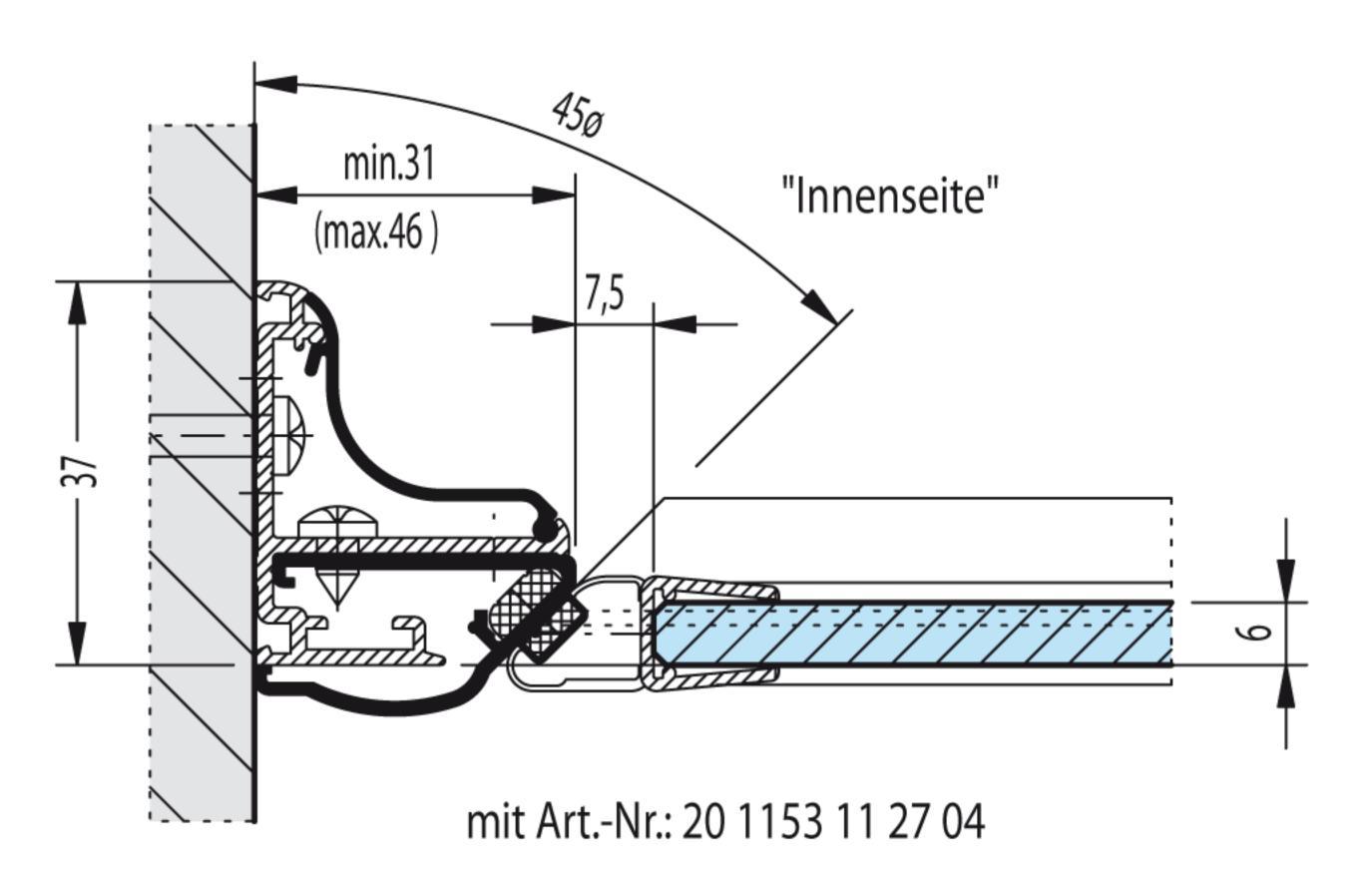
Türverschluss "45ø-Anschlagversion" mit 15 mm Breitenjustierung innerhalb der Profileinheit
